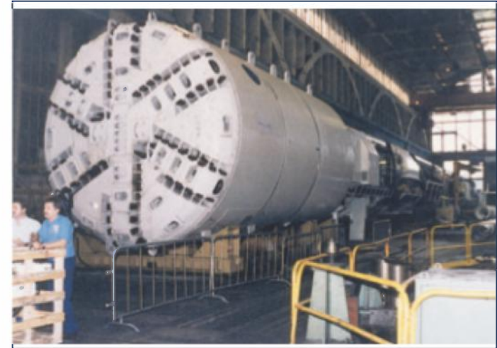
Le tunnelier Neyrpic-Framatome en cours de construction
